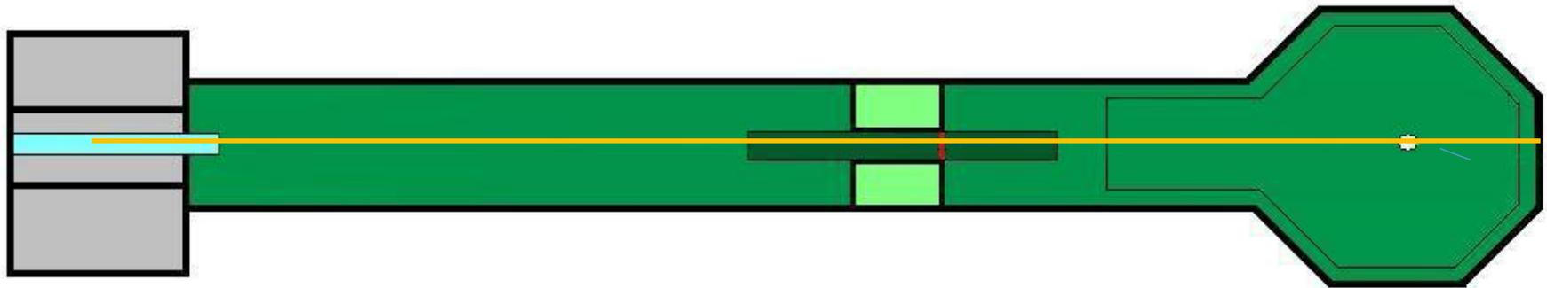
**BAHN 4 Steg durch Tunnel Länge: 9,25 m Breite: 90 cm**
